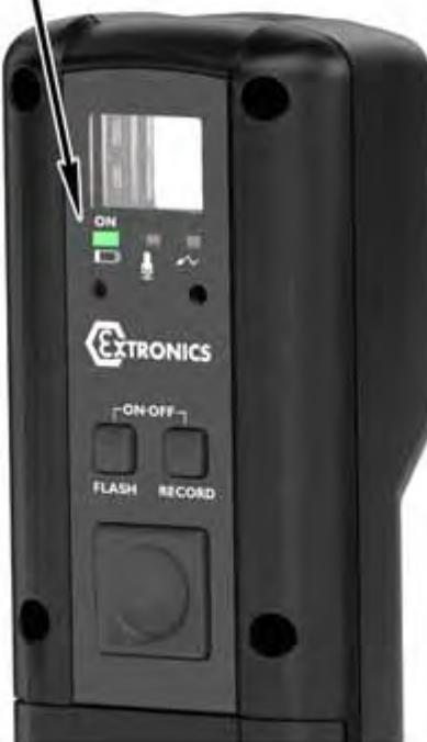
Die obenstehenden Abbildungen zeigen, wie die iCAM501U eingeschaltet wird. Das gleiche Verfahren ist zum Ausschalten der iCAM501U zu verwenden. Ist die Kamera ausgeschaltet, darf keine LED mehr leuchten.
