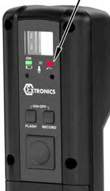
Pour prendre une photo, regardez dans le viseur et positionnez l'appareil de façon à voir ce que vous souhaiteriez photographier, le point d'intérêt devant être à 30 cm minimum de l'objectif. Vous pouvez utiliser le réticule pour cadrer l'image que vous souhaitez capturer. Notez que l'image réelle est d'environ 15 % plus grande d'un côté ou de l'autre de l'image réelle du viseur.
