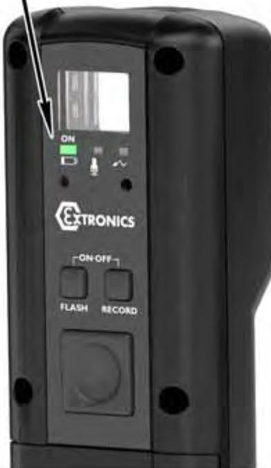
Les figures ci-dessus illustrent la procédure de mise en marche de l'iCAM501U. La même procédure est requise pour arrêter cet appareil. Après l'arrêt de l'iCAM501U, aucun voyant DEL ne doit être allumé.
