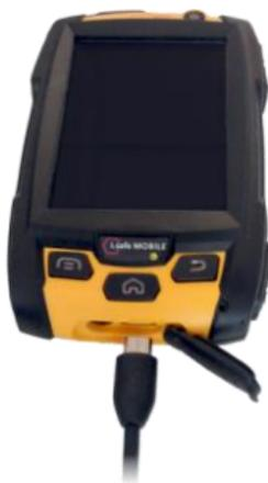
Kontaktieren Sie anschließend das Kabel mit dem Netzteil.
